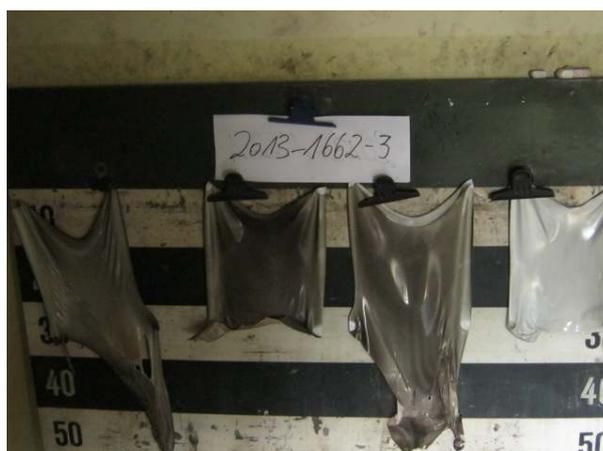
2.1.3 Normalentflammbarkeitsprüfung nach DIN 4102-1
