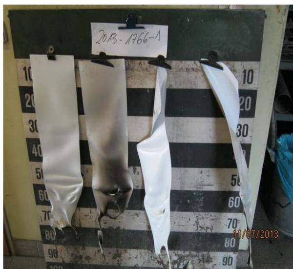
2.2.3 Normalentflammbarkeitsprüfung nach DIN 4102-1
